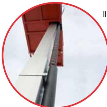
Il sistema rivoluzionario di sollevamento ideato dalla BRAVI PLATFORMS per tutti i suoi modelli di piattaforma mobile è un cambiamento radicale nel suo settore. La colonna in lega speciale di alluminio estruso è totalmente esente da qualsiasi tipo di manutenzione. Niente più catene da far ispezionare ogni anno - Niente più grasso alla colonna - Nessuna manutenzione richiesta!
